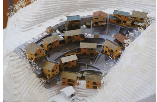
写真 4 ミニ等高線都市（牡鹿半島・前網浜の復興計画）の模型。海沿いのすり鉢状の斜面に住宅を配置し、漁民にとって安全で利便性の高い集落の再建を目指した。例えば、漁民の足である軽トラ用の通路が集落を巡り、海岸と背後の市道を連結している（宮本佳明、2012）
