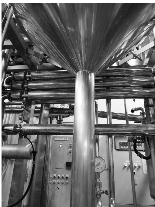
図1 真空脱気装置
