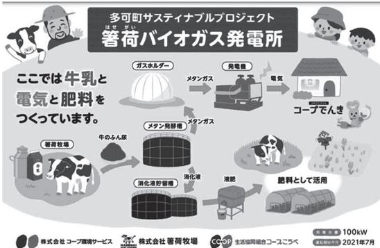
図7 箸荷バイオガス発電所 全体像
